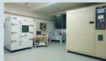
Испытательная камера с естественной конвекцией (слева), Камера для испытаний на термический удар (справа)
