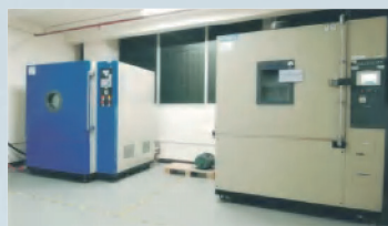
Камера для испытаний на пониженное атмосферное давление (слева), Камера для испытаний на постоянную температуру и влажность (справа)
